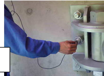
超音波探傷の例 (橋梁点検)
